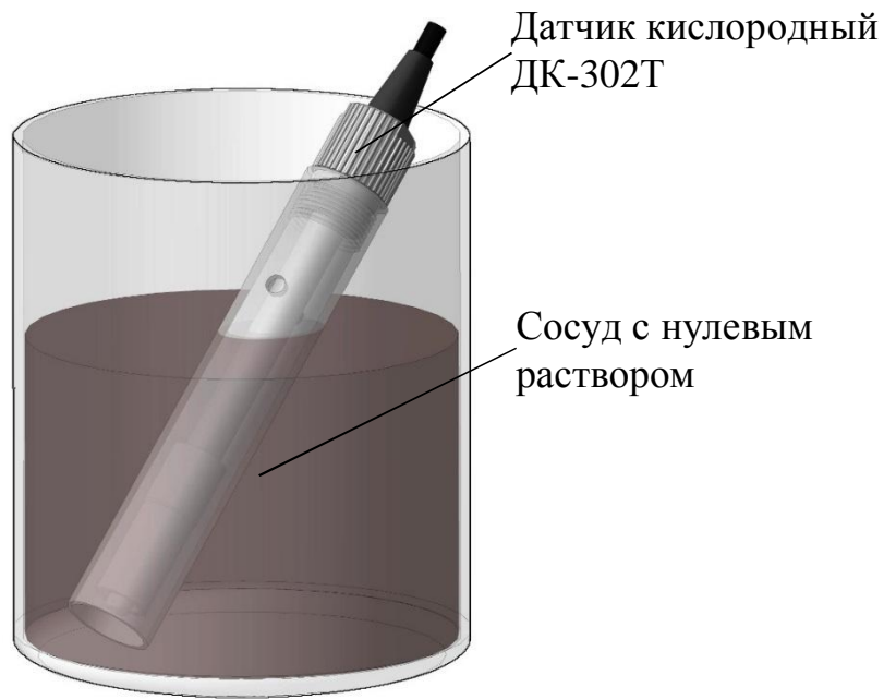
Рисунок 2.11 – Проверка показаний в «нулевом» растворе
