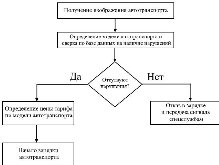
Рис. 2. Алгоритм работы зарядной станции с системой видеонаблюдения на искусственном интеллекте
