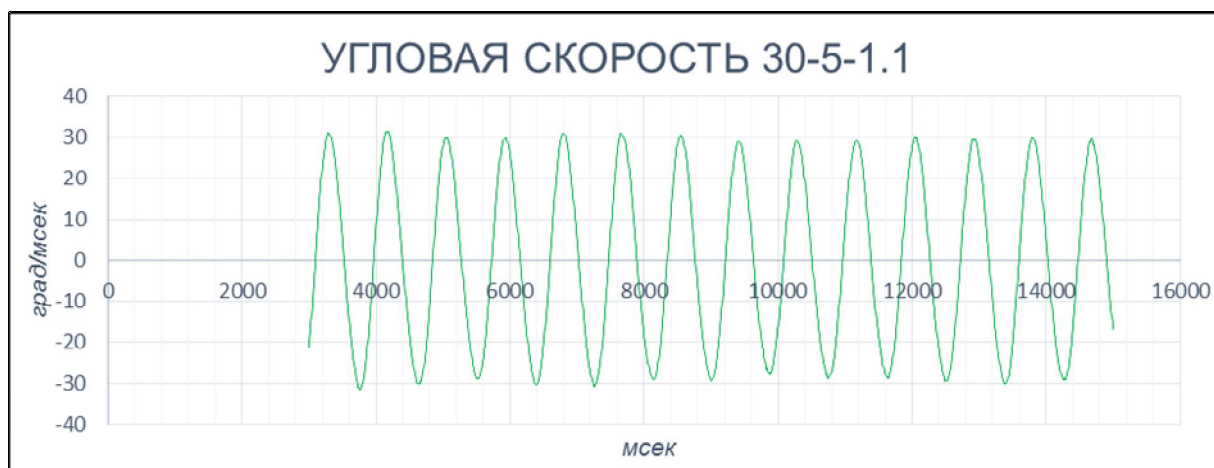
Рис. 1. График угловой скорости \omega = \omega(t) колебаний коромысла ветродвигателя
